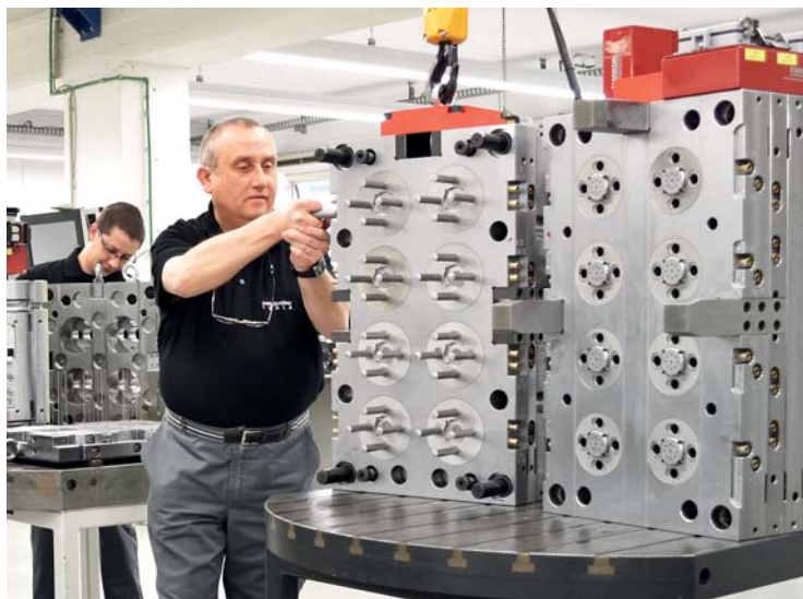
Рисунок 4. Окончательная сборка пресс-форм в цеху Ruhla
