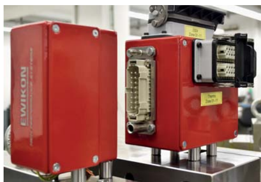
Рисунок 6. Благодаря быстроразъемному соединению плита с соплами легко снимается вместе со всей проводкой
