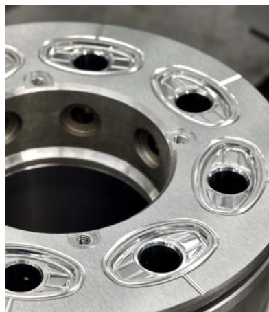
Рисунок 5. Вставка пресс-формы для производства цилиндров шприцев объемом 1 мл
