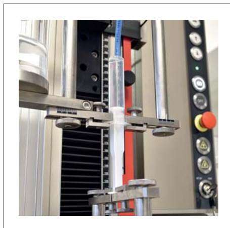
Рисунок 1. Специальная испытательная машина для контроля надлежащего функционирования готовых шприцев
